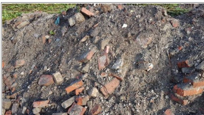
Abbildung 2: Haus 1.1 Bauschutt über Sand über Hausbrand bis 1,65 m Tiefe
